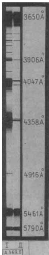
Bild 6 Absorptionsspektren von zwei Lösungen mit verschiedenem Verhältnis von Fe/Sulfosalicylsäure
